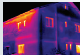
Detekcja strat ciepłych w budynkach: natychmiastowa lokalizacja mostków cieplnych
