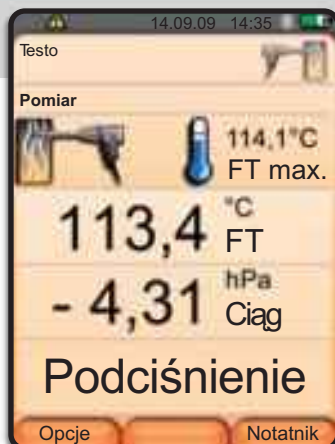
Wynik pomiaru: podciśnienie (-4.31 hPa)
