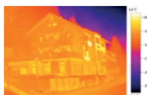
Obraz termowizyjny bez funkcji ScaleAssist
