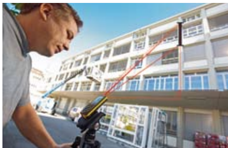
Pośredni pomiar wysokości: Wyznaczanie wysokości okien za pomocą funkcji Pitagoras.
